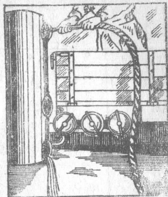
Рис. 5. Промывка колес Рашига в вертикальном очистителе.
