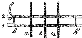
Рис. 72-й. Двѣ тетради, сшитыя швомъ, показаннымъ на рис. 71-мъ. Для ясности, тетради изображены на нѣкоторомъ разстояніи другъ отъ друга.
