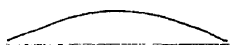
Рис. 145-й. Поперечный разрѣзъ выпуклой дощечки, подкладываемой подъ картоны, при тисненіи на немъ шрифткассою.
